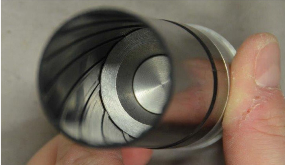
Abbildung 4: Innenansicht mit Zug-Feld-Profil, „TAG PALLADIN Launcher-Shell“
