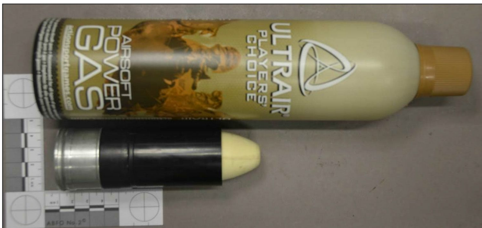
Abbildung 2: „TAG PALLADIN Launcher-Shell“ im geladenen Zustand (unten) mit vorgelegter Gasflasche
