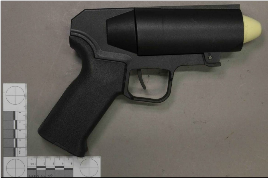
Abbildung 3: „TAG PALLADIN Launcher-Shell“ im geladenen Zustand eingesetzt in „Abschusspistole = Abschussgerät“
